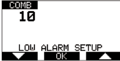
Figura 3-6. Configuración de una alarma de sensor
